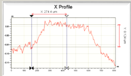
600 um membrane defelction, NO PRESSURE
